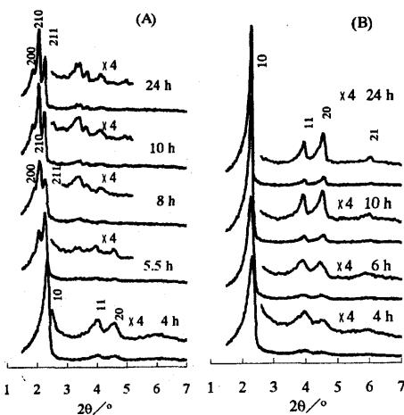
図5 1,2,3-TMBの存在下で生成する未焼成メソポーラス物質のXRD。仕込み比: TEOS : CTEABr : HCl : H<sub>2</sub>O : 1,2,3-TMB = 1 : 0.13 : 5 : 125 : x。1,2,3-TMB/CTEABr = (A) 0.3, (B) 0.5
