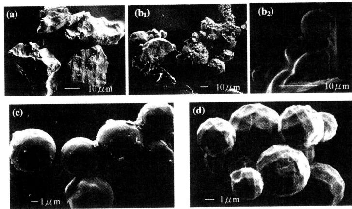
図6 図5Aで示したメソポーラス物質のSEM像。(a) 4 h, (b) 5.5 h, (c) 10 h, (d) 24 h
