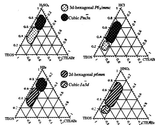
図1 硫酸、塩酸、臭化水素酸、硝酸の存在下で生成するメソポーラスシリカの構造の組成依存性。H<sub>2</sub>O/TEOS (mol)=125, 反応温度: 0°C, 反応時間: 1日
