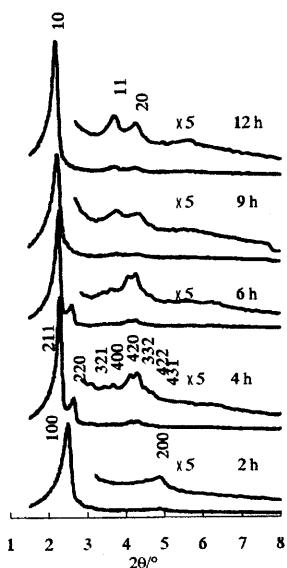
図8 硝酸の存在下で生成するメソポーラス物質のXRDの経時変化。合成ゲル仕込み比: CTEABr : TEOS :  $\text{HNO}_3 : \text{H}_2\text{O} = 0.13 : 1 : 2.5 : 125$
