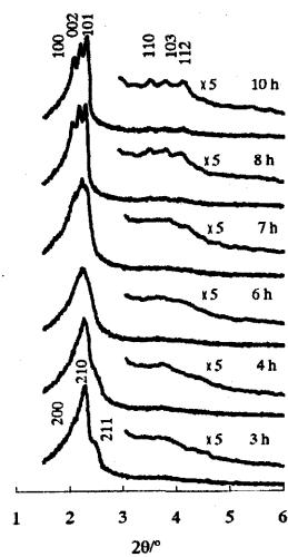
図4 硫酸の存在下で生成する未焼成メソポーラス物質のXRDの経時変化。合成ゲルの仕込み比: CTEABr : TEOS : H<sub>2</sub>SO<sub>4</sub> : H<sub>2</sub>O = 0.13 : 1 : 3.6 : 125
