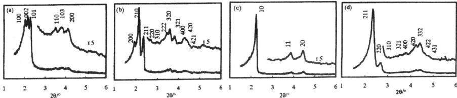
図2 硫酸、塩酸、臭化水素酸、硝酸の存在下で、それぞれ生成する3d-hexagonal  $P6_3/mmc$  (a), Cubic  $Pm\bar{3}n$  (b), 2d-hexagonal  $p6mm$  (c), Cubic  $Ia\bar{3}d$  (d)空間群を持つメソポーラスシリカのXRD
