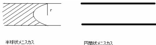
図2 Cohan によって考えられたシリンダー状細孔内の2種類の液面メニスカス
