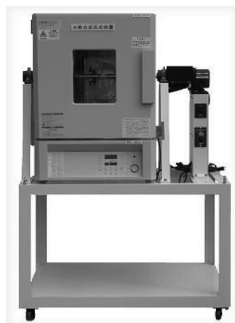
株式会社ヒロのオートクレーブと回転式水熱合成装置
