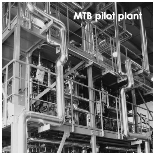
図9 牛の糞尿から得られるバイオガスを用いてベンゼンと水素を製造するバイオMTB実証試験プラント(20～50 kg触媒規模, 750～800℃, 0.1～0.3 MPa)の概観(北海道開発土木研究所別海有機資源循環利用施設, 2003～2007)
