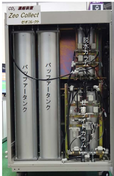
図6 大型二酸化炭素濃縮装置
