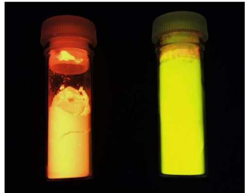
室温状態 (茜色に発光) 105°C以上 (レモン色に発光) 図7 銀含有A型ゼオライト蛍光体の水吸着による発光色の変化
