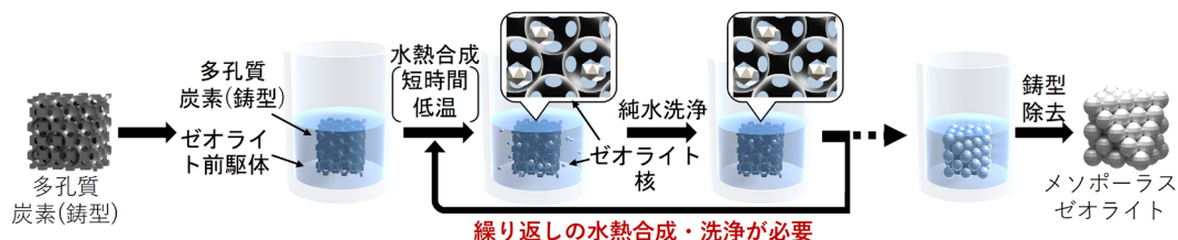
図2. 多孔質炭素を鋳型に用いた水熱合成法によるメソポーラスゼオライトの合成と課題。
